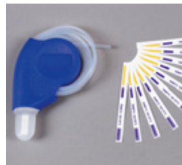
Test průniku páry dle ČSN EN 867-5
